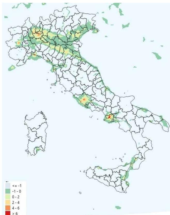
Fig. 21 – Variazione assoluta delle concentrazioni ( $\mu\text{g}/\text{m}^3$ ) di  $\text{O}_3$  nell'intero periodo di simulazione (febbraio – maggio 2020).
